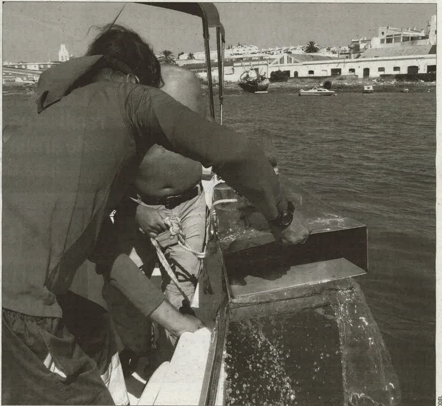
TÉCNICAS. Las trampas de sedimento se utilizan para analizar cuánta cantidad de arena transporta en río Guadiana.
