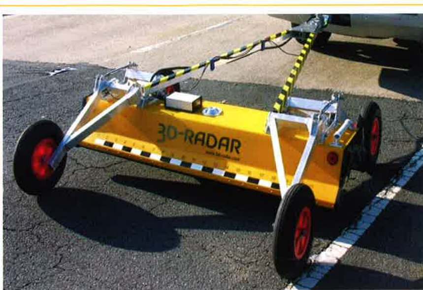
Sistema de antenas multicanal (21 antenas) para obtener registros tridimensionales de geo-radar. Modelo Geoscope Mk IV de Curtiss-Wright.
