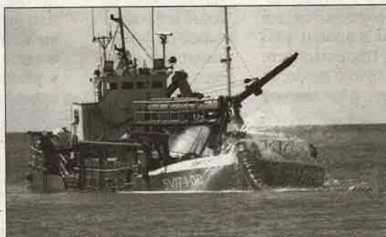
ACCIÓN. La draga, expulsando arena por la tubería.
