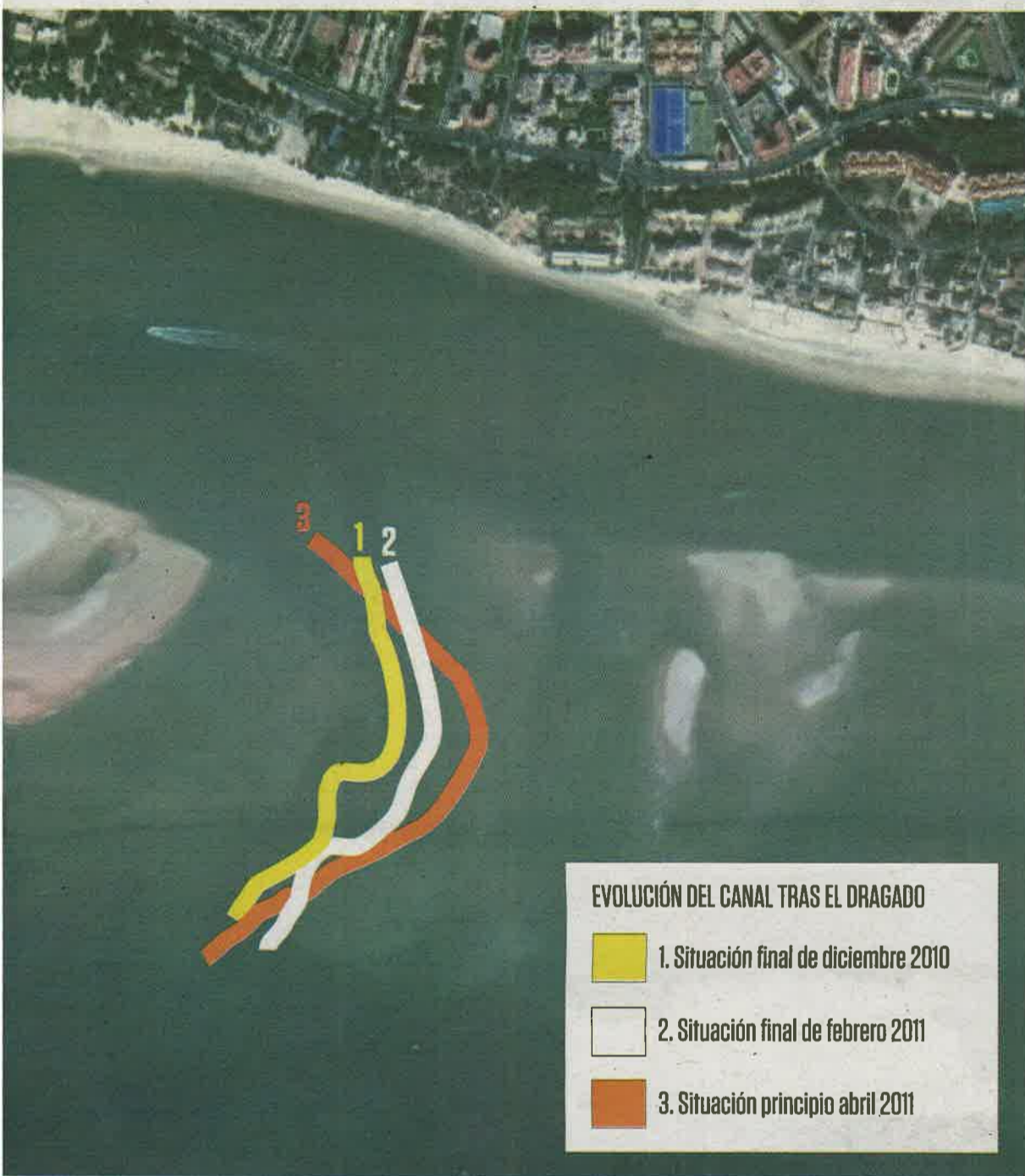
Las tres batimetrías realizadas tras el dragado muestran el desplazamiento del canal del Piedras. / Puerto Marina El Rompido
