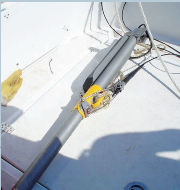
SONAR DE BARRIDO LATERAL. Pez de Sonar de la Universidad de Huelva (Marca CMAX Modelo 2000)
