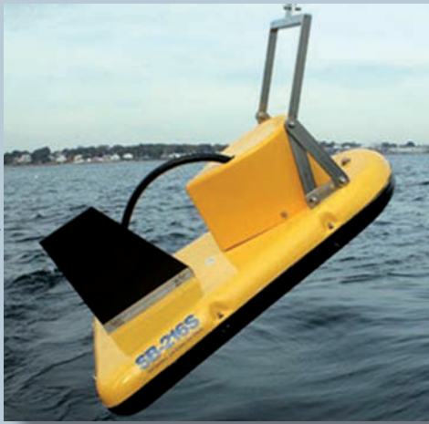
PENETRADOR SÍSMICO EJEMPLOS DE REGISTRO. PERFILADOR SÍSMICO. Marca EDGETECH 3100, Modelo SB-216S.
